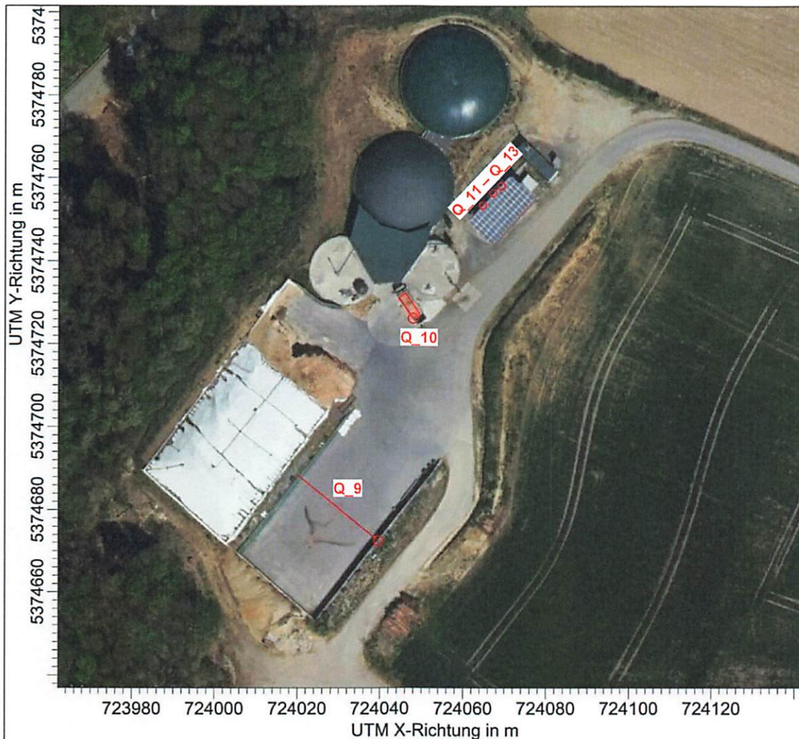
Abbildung 12: Luftbild mit Darstellung der modellierten Emissionsquellen der Biogasanlage /19/
