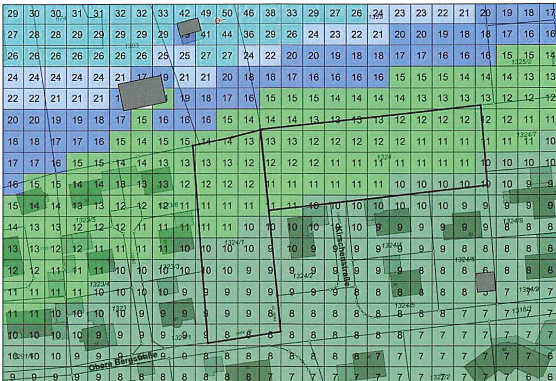
Abbildung 20: Geruchsstundenhäufigkeiten [% der Jahresstunden] im Plangebiet
