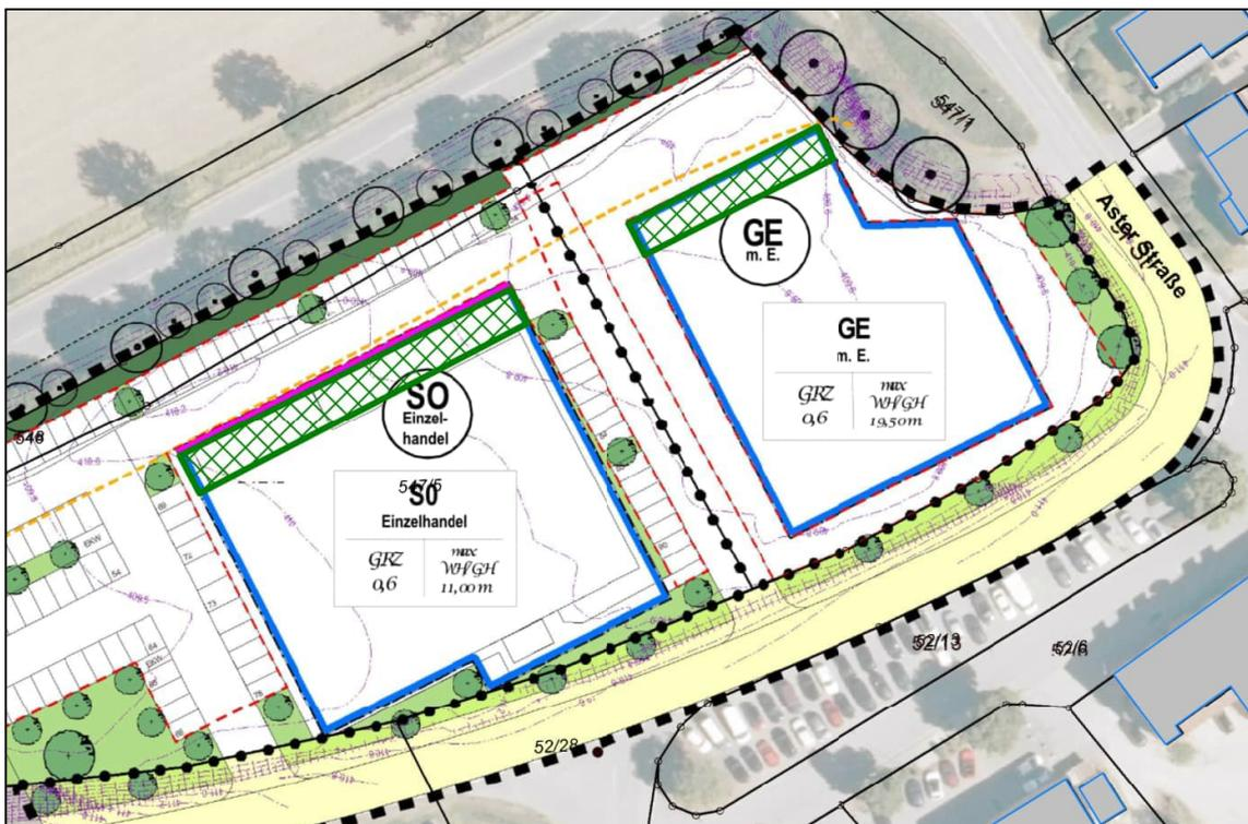
Abbildung 17: Lageplan mit Kennzeichnung der Bereiche, innerhalb derer Schallschutzmaßnahmen erforderlich sind
