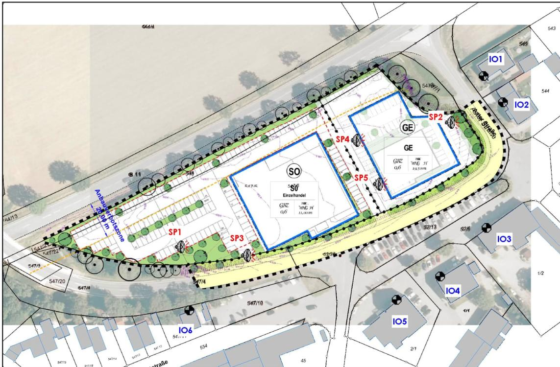
Abbildung 16: Lageplan mit Darstellung der Punktschallquellen (SP1-5)
